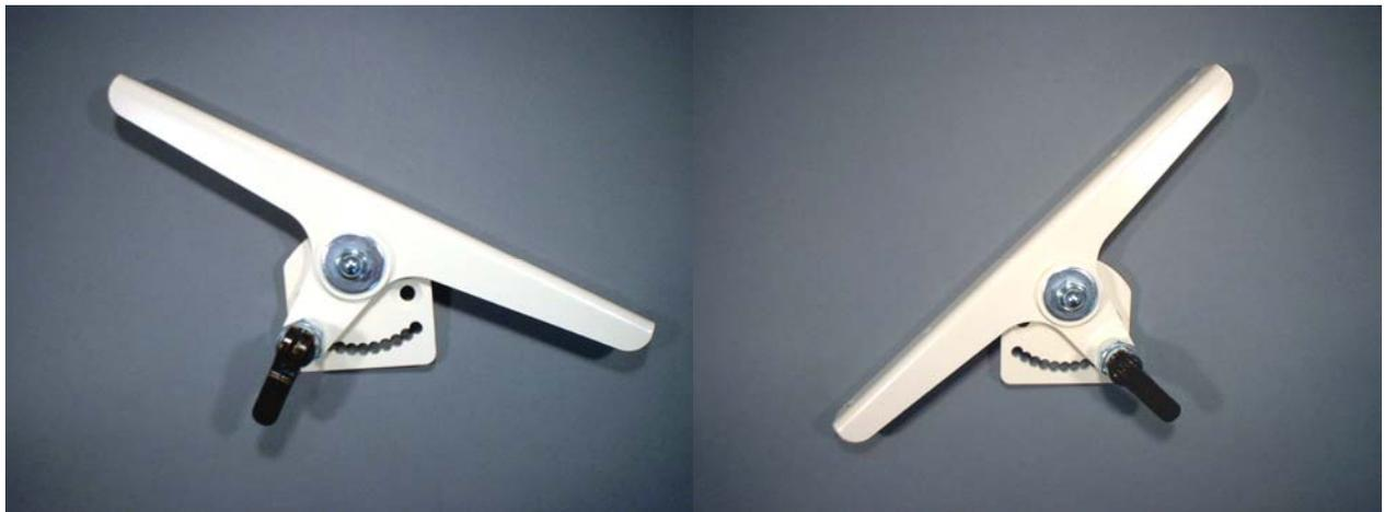
座センターに直接取り付けられたアームレストの支柱に用いる角度調整肘掛金具です。座背部のチルト角度に合わせて簡単にアームレストの角度を調整する事が出来ます。また、肘当パットに取り付けられたテーブルに角度をつける事が出来ます。ロック機構には、弊社開発のセーフティープランジャー(特許出願中)を採用しています。
