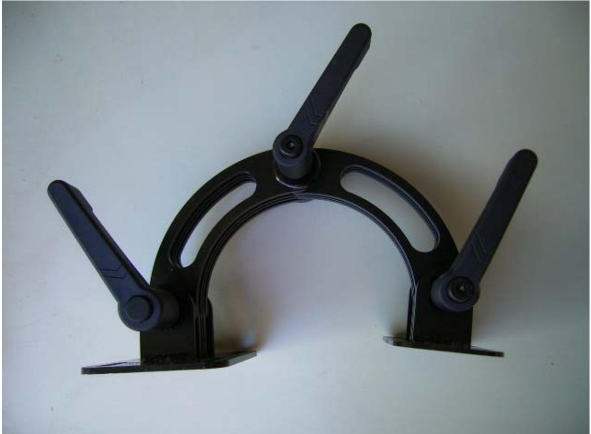
2リンク3関節式の強力固定タイプのヘッドレスト金具です。摩擦力を使った各関節の固定方法に独自の機構を採用し、強力で固定します。上下部分の固定にはクランプレバー、中央には同じくクランプレバーを配し容易に微妙な位置調整が出来ます。
